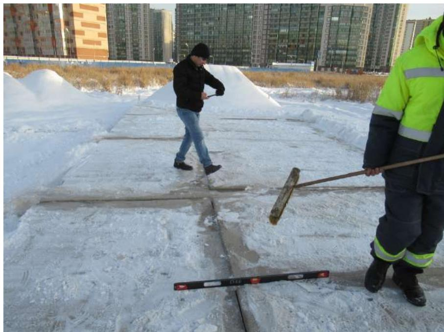
**Фото № 15.** Выполнение контрольных замеров величины превышения граней смежных плит сборных цементобетонных покрытий, уложенных на объекте исследования
