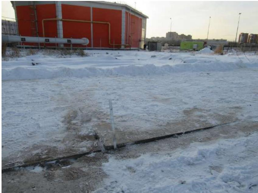
**Фото № 33.** Выполнение контрольных замеров величины превышения граней смежных плит сборных цементобетонных покрытий, уложенных на объекте исследования
