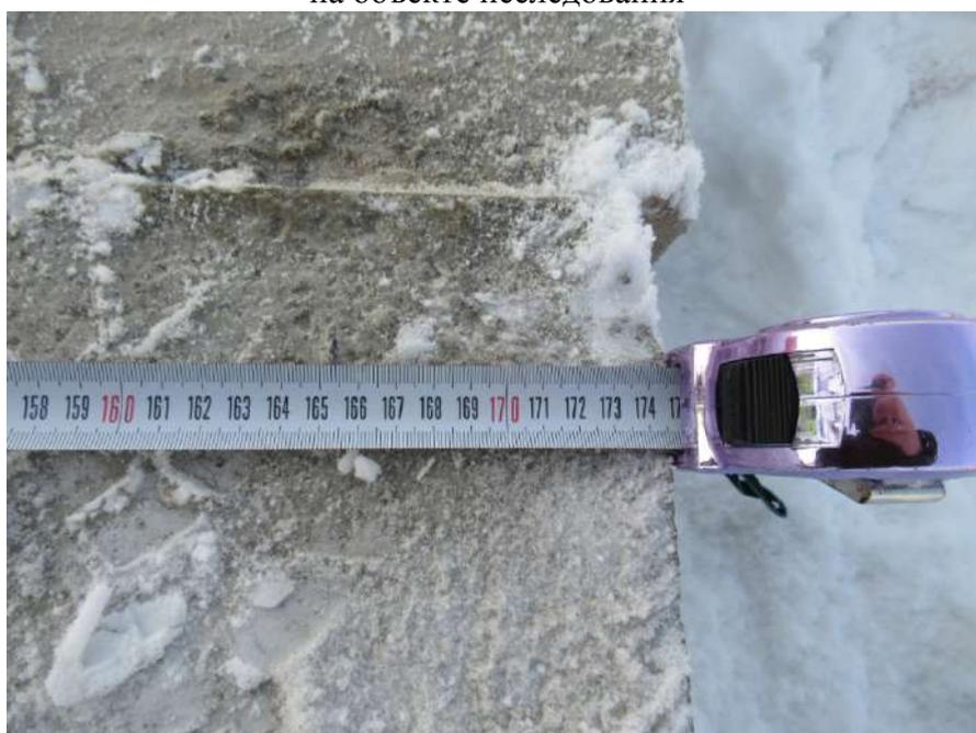
**Фото № 24.** Контроль габаритных размеров сборных цементобетонных покрытий, уложенных на объекте исследования (крупный план фото №23)
