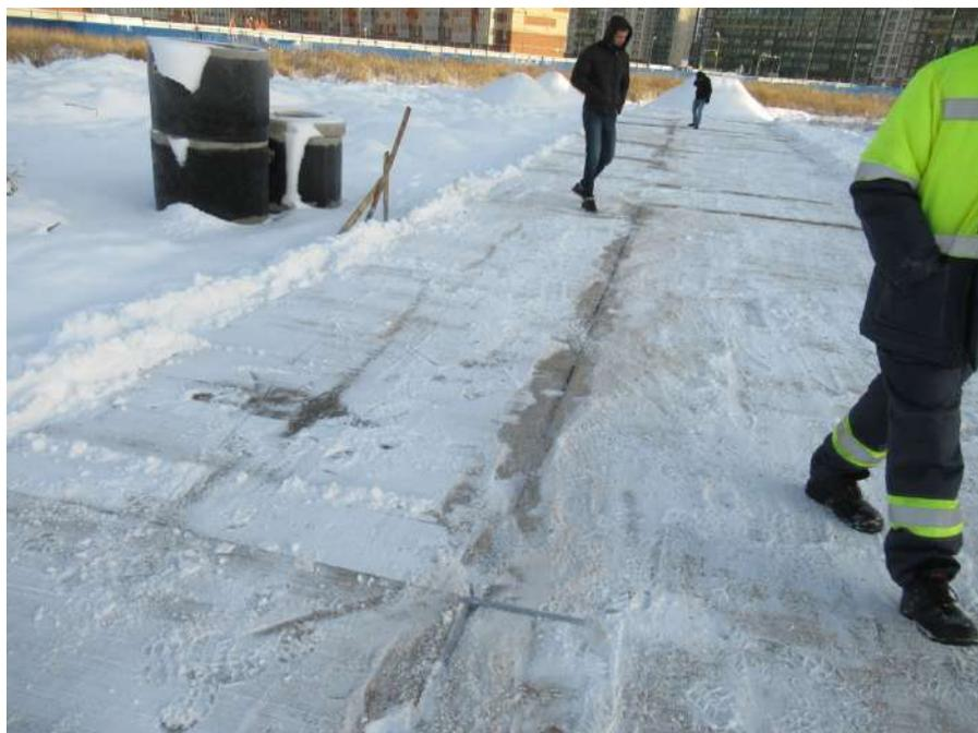
**Фото № 9.** Выполнение контрольных замеров величины раскрытия швов сборных цементобетонных покрытий, уложенных на объекте исследования
