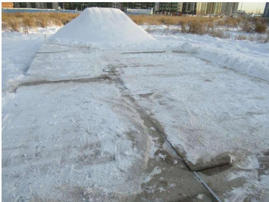
**Фото № 17.** Выполнение контрольных замеров величины раскрытия швов сборных цементобетонных покрытий, уложенных на объекте исследования
