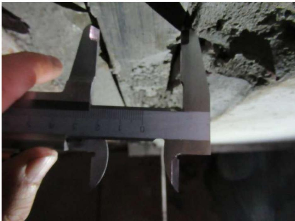
**Фото № 14.** Контрольный замер элементов усиления перекрытия подвала на втором участке ремонтируемого перекрытия исследуемого объекта.
